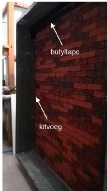
Fig. 8 t/m 12: opbouw van de testwand
